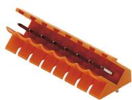
Connecteurs mâles avec sortie à 135°. La longueur des picots est optimisée pour la soudure à la vague. Ils peuvent être repérés et codés.
