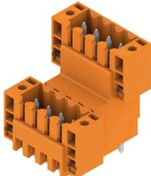
Connecteur mâle double-étage décalé, pour le procédé de soudage à la vague, au pas de 3,50 mm. Ils sont disponibles en versions fermée et avec bride. Les connecteurs mâles disposent d'espace pour les marquages et peuvent être codés.
