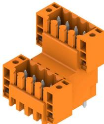
Connecteur mâle double-étage décalé, pour le procédé de soudage à la vague, au pas de 3,50 mm. Ils sont disponibles en versions fermée et avec bride. Les connecteurs mâles disposent d'espace pour les marquages et peuvent être codés.
