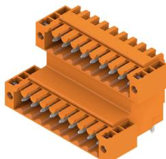
Connecteur mâle double-étage décalé, pour le procédé de soudage à la vague, au pas de 3,50 mm. Ils sont disponibles en versions fermée et avec bride. Les connecteurs mâles disposent d'espace pour les marquages et peuvent être codés.
