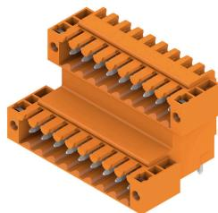
Connecteur mâle double-étage décalé, pour le procédé de soudage à la vague, au pas de 3,50 mm. Ils sont disponibles en versions fermée et avec bride. Les connecteurs mâles disposent d'espace pour les marquages et peuvent être codés.
