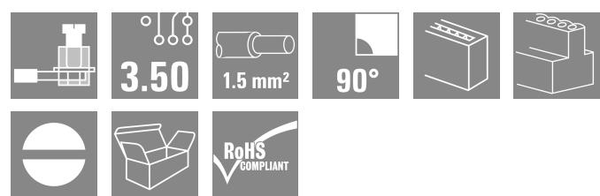
Connecteurs femelles avec raccordement à vis à étrier au pas de 3,50 mm. Ils disposent d'espace pour être repérés et peuvent être codés.
