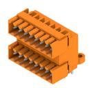
Connecteur mâle double étage pour le procédé de soudage à la vague, au pas de 3,50 mm. Le connecteur est disponible en versions ouverte, fermée et avec bride. Les connecteurs mâles disposent d'espace pour les marquages et peuvent être codés. Conditionné dans une boîte en carton.
