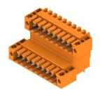
Connecteur mâle double-étage décalé, pour le procédé de soudage à la vague, au pas de 3,50 mm. Ils sont disponibles en versions fermée et avec bride. Les connecteurs mâles disposent d'espace pour les marquages et peuvent être codés.
