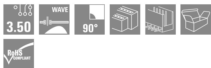
Connecteur mâle double étage pour le procédé de soufrage à la vague, au pas de 3,50 mm. Le connecteur est disponible en versions ouverte, fermée et avec bride. Les connecteurs mâles disposent d'espace pour les marquages et peuvent être codés. Conditionné dans une boîte en carton.
