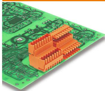
Connecteur mâle double-étage décalé, pour le procédé de soudage à la vague, au pas de 3,50 mm. Ils sont disponibles en versions fermée et avec bride. Les connecteurs mâles disposent d'espace pour les marquages et peuvent être codés.
