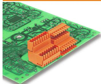
Connecteur mâle double-étage décalé, pour le procédé de soudage à la vague, au pas de 3,50 mm. Ils sont disponibles en versions fermée et avec bride. Les connecteurs mâles disposent d'espace pour les marquages et peuvent être codés.
