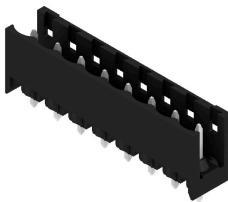
Connecteur mâle ouvert, droit, résistant aux hautes températures Conditionnement en boîte ou en rouleau. En rouleau, avec picot à souder 1,5 mm, optimisé pour l'implantation automatique. Longueurs de picots de 3,2 mm indiquées pour les applications de soudure à la vague et par refusion. Les connecteurs mâles disposent d'espace pour les marquages et peuvent être codés. HC = Courant fort.
