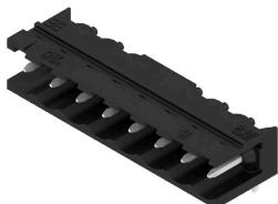
Connecteur mâle ouvert, coudé 90°, résistant aux hautes températures. Conditionnement en boîte ou en rouleau. En rouleau, avec picot à souder 1,5 mm, optimisé pour l'implantation automatique. Longueurs de picots de 3,2 mm indiquées pour les applications de soudure à la vague et par refusion. Les connecteurs mâles disposent d'espace pour les marquages et peuvent être codés. HC = Courant fort.
