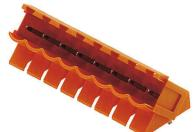
Connecteurs mâles avec sortie à 135°. La longueur des picots est optimisée pour la soudure à la vague. Ils peuvent être repérés et codés.
