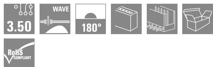
Connecteurs mâles pour le procédé de soudage à la vague, au pas de 3,50 mm
