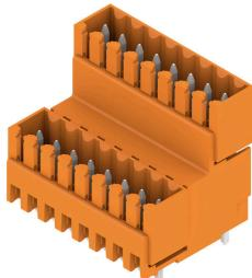
Connecteur mâle double-étage décalé, pour le procédé de soudage à la vague, au pas de 3,50 mm. Ils sont disponibles en versions fermée et avec bride. Les connecteurs mâles disposent d'espace pour les marquages et peuvent être codés.
