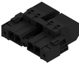
Connecteur mâle inversé à 180° avec raccordement PUSH IN pour câblage de terrain 6 mm<sup>2</sup> au pas de 7,62, réalisant une « version à trois brides » pour passage boîtier. Convient aux boîtiers dont l'épaisseur de paroi ne dépasse pas 2 mm. En plus, convient idéalement aux solutions de protection des doigts pour tensions inverses. Satisfait les exigences des normes UL1059 600 V classe C et CEI 61800-5-1.
