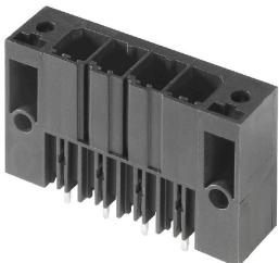
Connecteur mâle puissant monorangée, juxtaposable sans perte de pôles ou avec système de brides breveté pour verrouillage rapide et sans outil. Fiabilité de raccordement et de fonctionnement maximale grâce à une face d'enfichage qui empêche tout raccordement erroné, avec une diversité de codage unique, fixations supplémentaires de la bride. Longueur des picots 3,5 mm optimisée pour la soudure à la vague sans plomb.
