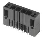
Connecteur mâle puissant monorangée, juxtaposable sans perte de pôles ou avec système de brides breveté pour verrouillage rapide et sans outil. Fiabilité de raccordement et de fonctionnement maximale grâce à une face d'enfichage qui empêche tout raccordement erroné, avec une diversité de codage unique, fixations supplémentaires de la bride. Longueur des picots 3,5 mm optimisée pour la soudure à la vague sans plomb.
