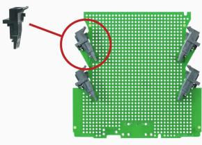
Connecteur mâle ouvert, droit, résistant aux hautes températures Conditionnement en boîte ou en rouleau. En rouleau, avec picot à souder 1,5 mm, optimisé pour l'implantation automatique. Longueurs de picots de 3,2 mm indiquées pour les applications de soudure à la vague et par refusion. Les connecteurs mâles disposent d'espace pour les marquages et peuvent être codés. HC = Courant fort.
