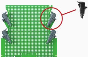
Connecteur mâle ouvert, droit, résistant aux hautes températures Conditionnement en boîte ou en rouleau. En rouleau, avec picot à souder 1,5 mm, optimisé pour l'implantation automatique. Longueurs de picots de 3,2 mm indiquées pour les applications de soudure à la vague et par refusion. Les connecteurs mâles disposent d'espace pour les marquages et peuvent être codés. HC = Courant fort.
