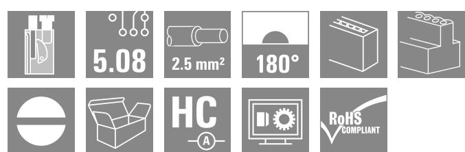
Connecteurs femelles avec raccordement vissé TOP pour le raccordement de conducteurs avec orientation de sortie droite 180°. Les connecteurs femelle disposent d'espace pour les marquages et peuvent être codés. HC = Courant fort.
