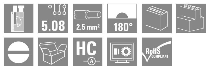
Connecteurs femelles avec raccordement vissé TOP pour le raccordement de conducteurs avec orientation de sortie droite 180°. Les connecteurs femelle disposent d'espace pour les marquages et peuvent être codés. HC = Courant fort.
