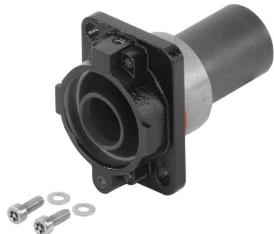
Le boîtier de protection est fabriqué à partir d'aluminium résistant à l'eau de mer, par coulage sous pression. Un haut niveau de protection contre l'eau et la poussière, ainsi qu'une résistance aux chocs particulièrement élevée, constituent la marque de fabrique de cette série de boîtiers.
