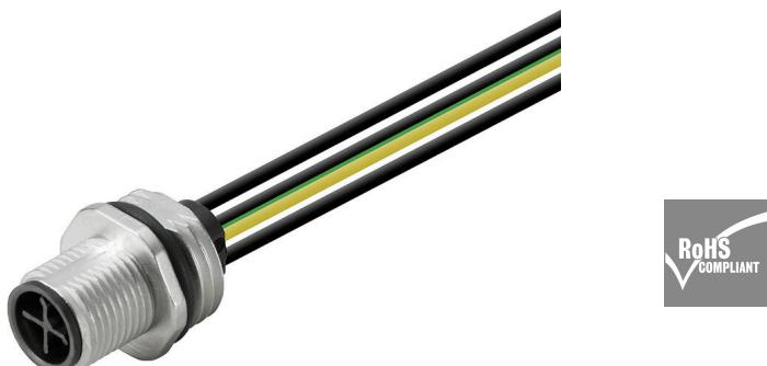
Vos appareils périphériques ont besoin d'une alimentation plus forte. Nos nouveaux connecteurs débrochables M12 supportent sans problème 250 V et 2 A. Les connecteurs débrochables compacts M12 à codage A-, K-, L-, S et T sont conçus pour transmettre jusqu'à 630 V AC ou 60 V DC et 12 A.
