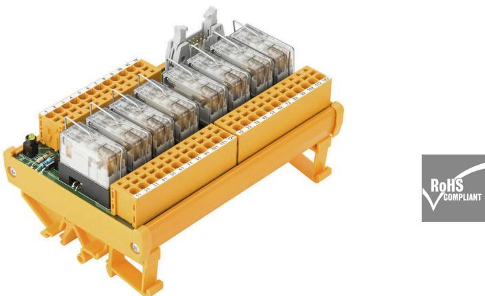
Embase relais (RSM) avec positif commun et négatif commun à raccorder à un API ou à un autre type de contrôleur. Les interfaces sont constituées de deux groupes de 4, 8 ou 16 relais RCL (12,7 mm) ou RSS (6,1 mm). Le raccordement avec le contrôleur peut être réalisé à l'aide de connecteurs débrochables ou par câblage direct, avec des connecteurs CEI 60603-13. Large choix d'options :
