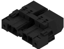
Connecteur mâle inversé à 180° avec raccordement PUSH IN pour câblage de terrain 6 mm<sup>2</sup> au pas de 7,62, réalisant une « version à trois brides » pour passage boîtier. Convient aux boîtiers dont l'épaisseur de paroi ne dépasse pas 2 mm.
