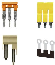
La distribution ou la multiplication d'un potentiel aux blocs de jonction adjacents est réalisée par une connexion transversale. Un effort supplémentaire de câblage peut être facilement évité. Même si les pôles sont cassés, la fiabilité des contacts dans les blocs de jonction est toujours assurée. Notre portefeuille offre des systèmes de connexion transversale enfichables et visssables pour les blocs de jonction modulaires.
