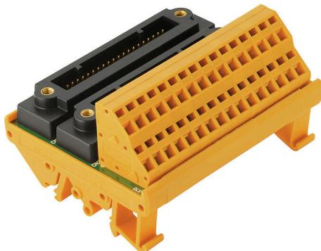
Les interfaces analogiques sont équipées de connecteurs 40 pôles (KS). Les versions sont disponibles avec fiches de sectionnement et prises de test, qui sont extrêmement utiles pour les mesures de tension et de courant. Il existe également des versions avec des broches supplémentaires, utiles aux clients qui souhaitent intégrer d'autres éléments (résistances, ...) pour des conversions de tension/courant ou pour la surveillance de la boucle de courant.
