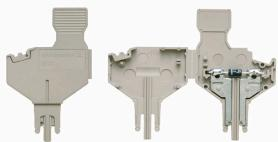
La fiche avec composant est utilisée pour intégrer des composants électrique dans un bloc de jonction sectionnable. Après avoir soudé les composants électroniques, le mâle peut être intégré dans la zone de déconnexion de nos blocs de jonction sectionnable et change ainsi le bloc de jonction sectionnable en bloc de jonction modulaire avec composants intégrés.
