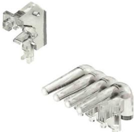
Efficace : le lien entre la LED et le panneau frontal. Les indicateurs Floodlight permettent aux utilisateurs de surveiller les états de commutation sans demander une forme boîtier spéciale : le plastique optique dirige la lumière des LED standard autour d'un virage dans les connecteurs ou à travers la plaque avant.
