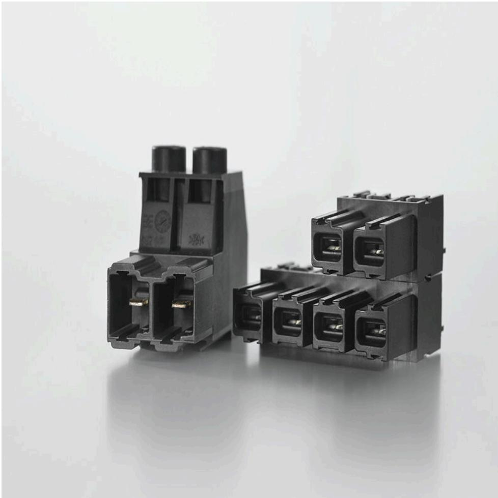
La géométrie de la face du connecteur évite le raccordement de connecteurs ayant des nombres de pôles différents. Seuls des connecteurs ayant le même nombre de pôles peuvent s'assembler.
