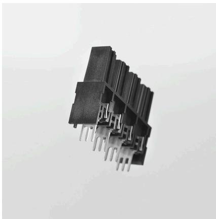
Trois picots à souder par pôle garantissent la force mécanique nécessaire et la conduction maximale du courant.
