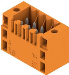
Connecteur mâle droit double rangée disponible en version avec extrémités latérales fermées ou avec brides (extrémités latérales ouvertes sur demande). Les connecteurs mâles avec une longueur de picot de 3,5 mm sont conçus pour la soudure à la vague et sont conditionnés en boîte. Ils peuvent être vissés sur le circuit imprimé. Les connecteurs mâles disposent d'espace pour les marquages et peuvent être codés.
