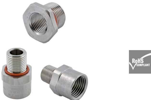
Les adaptateurs de la série ADAP offrent flexibilité et polyvalence en remplaçant les entrées inutilisées des équipements Ex, tout en maintenant une protection antidéflagrante Ex d, une protection contre les explosions Ex e à sécurité accrue et un indice de protection IP66/67/68.
