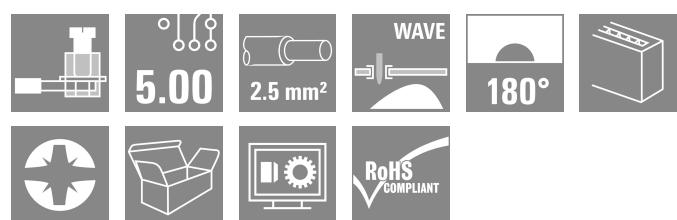
Bloc de jonction pour circuit imprimé multirangée avec raccordement à étrier éprouvé au pas de 5,00 et 5,08 mm. Sortie de fil à 90°, 135° et 180°. Section jusqu'à 2,5 mm<sup>2</sup>.
