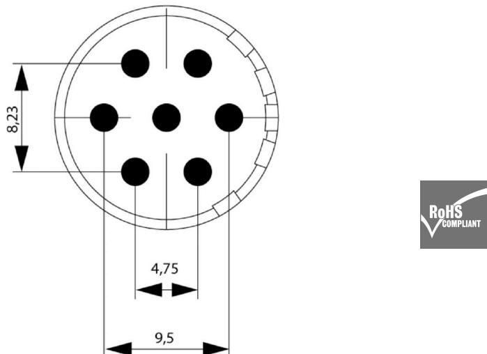
Les connecteurs débrochables arrondis M23 offrent un grand nombre de cycles d'embrochage-débrochage, un courant admissible élevé et une densité de contact élevée de dimensions minimales.
