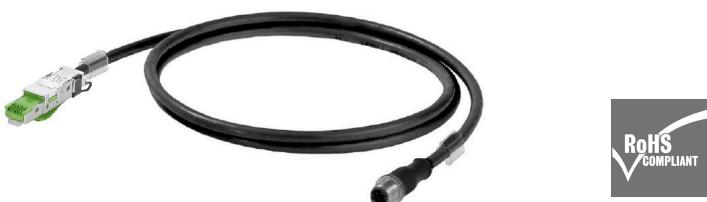
Câbles assemblés IE, câble ferroviaire RW (diminué), cat. 5, PUR, noir, connecteur RJ45, sans outils, IP20 et broche droite M12.
