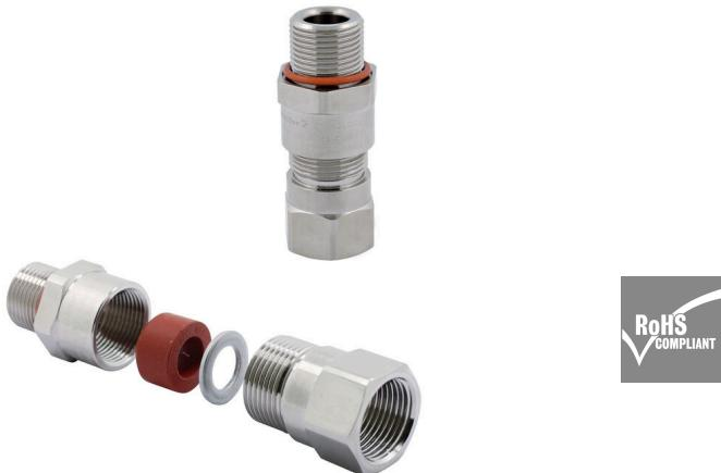
Les presse-étoupes de type A2LC conviennent pour les câbles non armés et fournissent un raccord de conduit à filetage femelle. Ils maintiennent une protection antidiéflagrante Ex d et une protection contre les explosions Ex e à sécurité accrue
