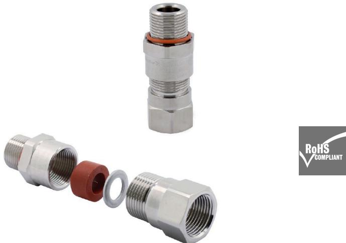
Les presse-étoupes de type A2LC conviennent pour les câbles non armés et fournissent un raccord de conduit à filetage femelle. Ils maintiennent une protection antidiéflagrante Ex d et une protection contre les explosions Ex e à sécurité accrue
