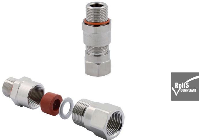
Les presse-étoupes de type A2LC conviennent pour les câbles non armés et fournissent un raccord de conduit à filetage femelle. Ils maintiennent une protection antidiéflante Ex d et une protection contre les explosions Ex e à sécurité accrue
