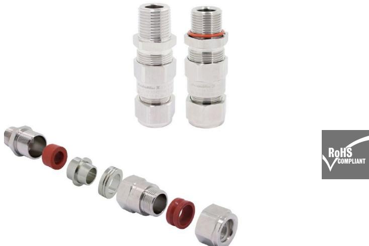
Les presse-étoupes de type E1XZ conviennent aux câbles armés en acier tressé SWB ou en acier STA. Ils maintiennent une protection antidéflagrante Ex d et une protection contre les explosions Ex e à sécurité accrue. Le serrage de l'armure assure en outre une liaison électrique entre l'armure du câble et les presse-étoupes.
