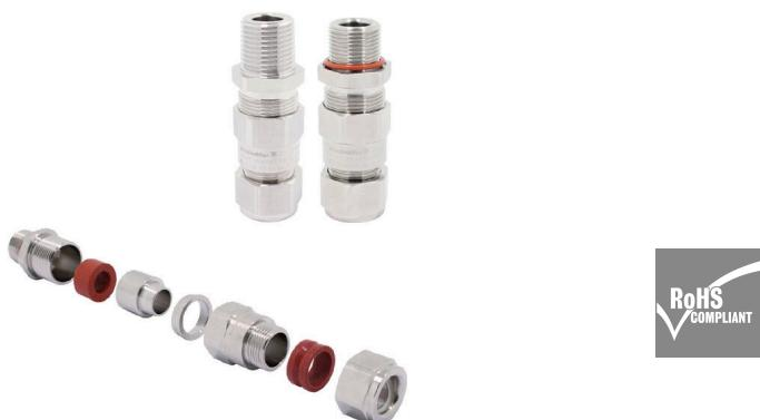
Les presse-étoupes de type E1W conviennent aux câbles armés en acier SWA. Ils maintiennent une protection anti-déflagrante Ex d et une protection contre les explosions Ex e à sécurité accrue. Le serrage de l'armure assure en outre une liaison électrique entre l'armure du câble et les presse-étoupes.
