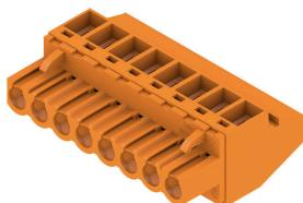
Connecteurs femelles avec raccordement à étrier pour le raccordement de conducteurs à orientation de sortie à angle droit (90° ou 270°). Les connecteurs femelle disposent d'espace pour les marquages et peuvent être codés. Fixation par bride ou par levier de verrouillage. Ils disposent également d'une vis plus/moins intégrée et d'une protection contre toute mauvaise insertion du connecteur. Ils sont livrés avec étriers ouverts. HC = Courant fort.
