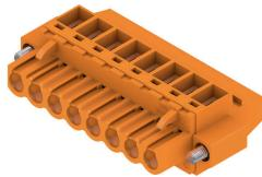
Connecteurs femelles avec raccordement à étrier pour le raccordement de conducteurs à orientation de sortie à angle droit (90° ou 270°). Les connecteurs femelle disposent d'espace pour les marquages et peuvent être codés. Fixation par bride ou par levier de verrouillage. Ils disposent également d'une vis plus/moins intégrée et d'une protection contre toute mauvaise insertion du connecteur. Ils sont livrés avec étiers ouverts. HC = Courant fort.
