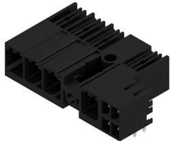
Connecteur mâle combiné à 90° avec contacts de signaux et de puissance avec raccordement PUSH IN incluant une bride centrale à verrouillage et (en option), un raccordement de blindage enfichable, au pas de 7,62. Permet le raccordement simultané de la puissance, des signaux et (en option) d'un blindage CEM. Idéal pour le raccordement d'entraînements par servomoteur et asynchrones.
