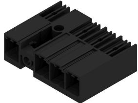
Connecteur mâle à 90° avec fixation par bride à souder, au pas de 7,62 pour les réseaux IT 400 V, selon CEI 61800-5-1.
