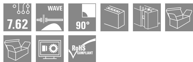
Connecteur mâle à 90° avec fixation par bride à souder, au pas de 7,62 pour les réseaux IT 400 V, selon CEI 61800-5-1.
