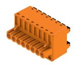
La solution performante "Daisy-Chain" permettant de réaliser un bus avec des signaux de puissance peut être utilisée pour des alimentations auxiliaires jusqu'à 18,5 A sous 400V. La capacité de raccorder des sections jusqu'à 2,5mm² est particulièrement intéressante pour réaliser des bus sur de longues distances grâce à la faible chute de tension dans les contacts.
