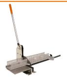
Outil manuel à couper pour canaux de câblage et couvercles ; jusqu'à 125 mm de largeur et une épaisseur de paroi de 2,5 mm. Uniquement pour des plastiques non renforcés par des matières de remplissage
