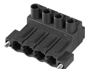
Connecteur mâle inversé à 180° avec raccordement à étrier pour câblage de terrain 2,5 mm<sup>2</sup> au pas de 7,62. En plus, convient idéalement comme solution de protection des doigts pour tensions inverses.
