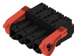
Connecteur mâle inversé à 180° avec raccordement PUSH-IN pour câblage de terrain 2,5 mm<sup>2</sup> au pas de 7,62. En plus, convient idéalement comme solution de protection des doigts pour tensions inverses. Satisfait les exigences des normes UL1059 600 V classe C et CEI 61800-5-1. Versions : disponible sans bride, avec bride externe, avec levier de verrouillage.
