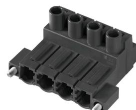
Connecteur mâle inversé à 180° avec raccordement à étrier pour câblage de terrain 2,5 mm<sup>2</sup> au pas de 7,62. En plus, convient idéalement comme solution de protection des doigts pour tensions inverses. Satisfait les exigences des normes UL1059 600 V classe C et CEI 61800-5-1. Versions : disponible sans bride, avec bride externe ou avec levier de verrouillage.
