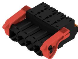
Connecteur mâle inversé à 180° avec raccordement PUSH-IN pour câblage de terrain 2,5 mm<sup>2</sup> au pas de 7,62. En plus, convient idéalement comme solution de protection des doigts pour tensions inverses. Satisfait les exigences des normes UL1059 600 V classe C et CEI 61800-5-1. Versions : disponible sans bride, avec bride externe, avec levier de verrouillage.
