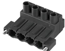
Connecteur mâle inversé à 180° avec raccordement à étrier pour câblage de terrain 2,5 mm<sup>2</sup> au pas de 7,62. En plus, convient idéalement comme solution de protection des doigts pour tensions inverses. Satisfait les exigences des normes UL1059 600 V classe C et CEI 61800-5-1. Versions : disponible sans bride, avec bride externe ou avec levier de verrouillage.
